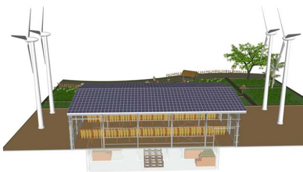
图1 多能互补乡村一体式晾晒场-冷鲜库示意图
